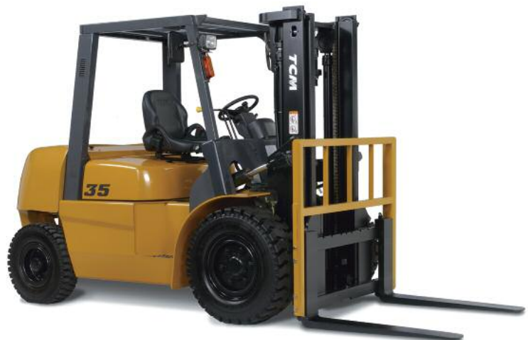
Die Baureihe FD/FG35-50 T2 umfasst Diesel- und Gas-Gegengewichtsstapler in den Tragkraftklassen von 3,5 bis 5,0 t
