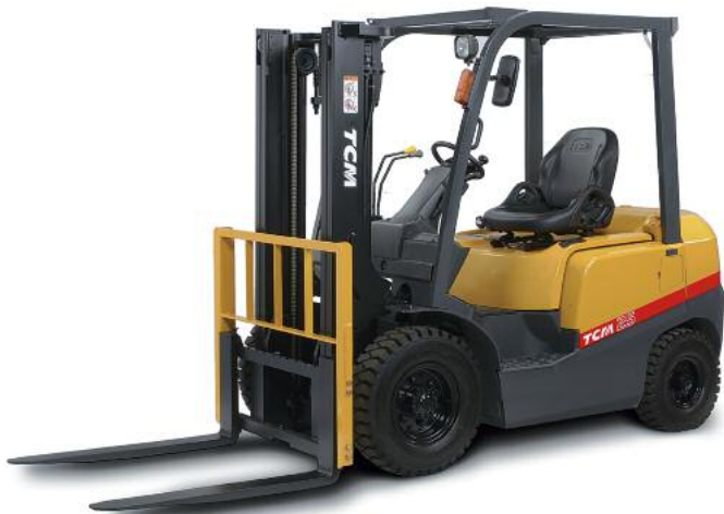
Die Baureihe Inoma besteht aus Diesel- und Treibgas-Gegengewichtsstaplern mit Tragfähigkeiten von 1,5 bis 3,5 t
